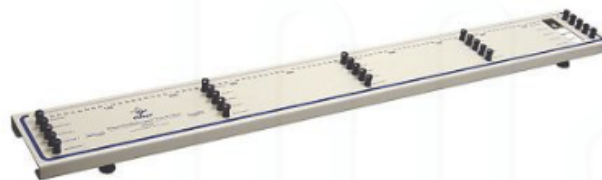
Figura 1: Painel de fios para leis de Ohm.
